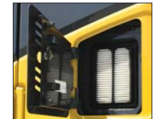
Filtro de aire externo del acondicionador de aire
