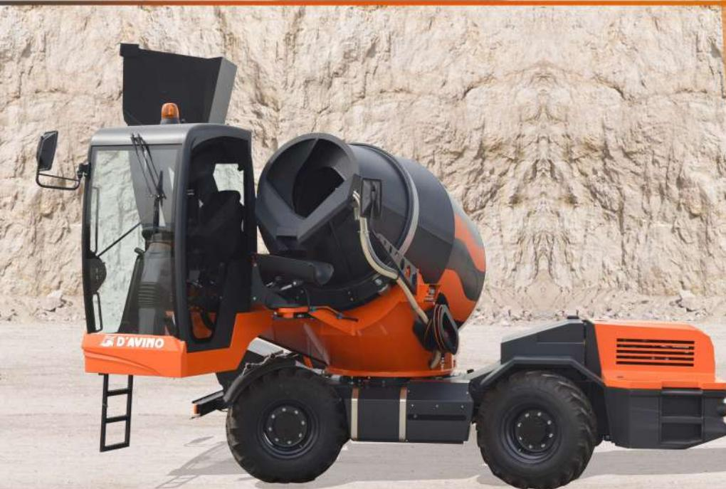
**DESCRIPCIÓN** (UNI 10929:2011) Autohormigonera autocargante – Hormigón producido 3,0 m<sup>3</sup> (tipo S1) – Dirección de carga anterior – Dirección de descarga giratoria a 270° – N.4 ruedas motrices y direccionales – Carga mediante pala rígida – Cabina soldada al tambor y giratoria a 270°
