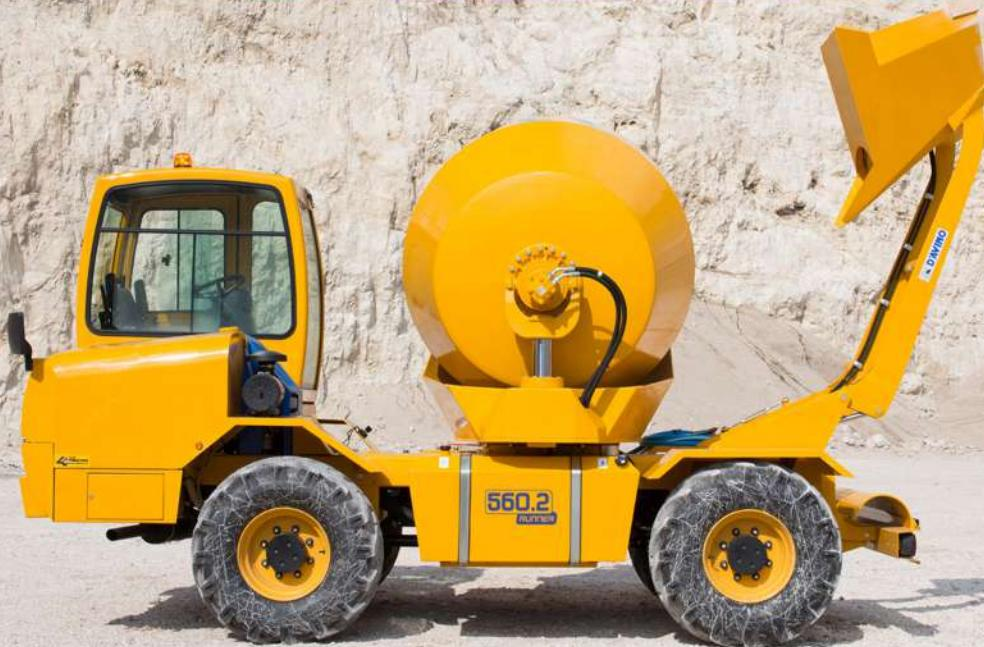
**DESCRIPCIÓN** (UNI 10929:2011) Autohormigonera autocargante – Hormigón producido 4,5 m<sup>3</sup> (tipo S1) – Dirección de carga posterior – Dirección de descarga giratoria a 180° - N.4 ruedas motrices y direccionales – Carga mediante pala rígida
