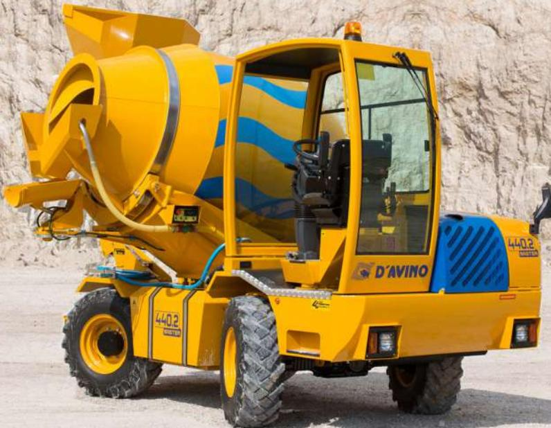
**DESCRIPCIÓN** (UNI 10929:2011) Autohormigonera autocargante – Hormigón producido 2,6 m3 (tipo S1) – Dirección de carga posterior – Dirección de descarga giratoria a 180° – N.4 ruedas motrices y direccionales – Carga mediante pala rígida
