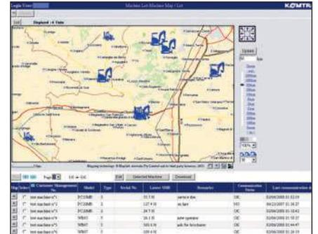
*Localización de la flota – El sistema localiza instantáneamente todas las máquinas, incluidas aquellas ubicadas en otros países.*
