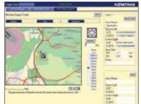
*Mayor seguridad – La función “bloqueo del motor” permite programar el momento de arranque del motor de una máquina. Con la opción “geo-fence”, Komtrax envía una notificación cada vez que la máquina traspasa una zona de operación predeterminada.*
